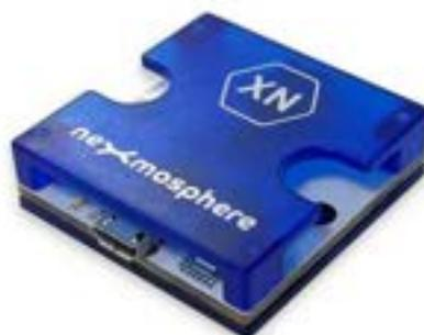
Il sensore forma un piano circolare interattivo che può essere segmentato in più zone di attivazione. Una volta che una zona viene raggiunta, in questo caso dalla mano dell'acquirente, il contenuto pertinente per quell'area viene visualizzato sullo schermo.
