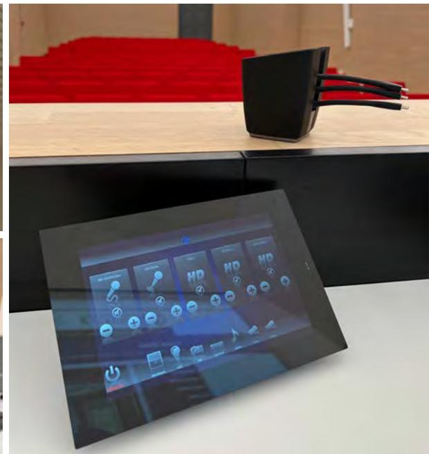
Da sinistra: il touchpanel di controllo HDL con retroilluminazione a LED; la multipresa BachMann; il vassoio con i button del Barco ClickShare CX-30; il touchpanel RTI KA8.
