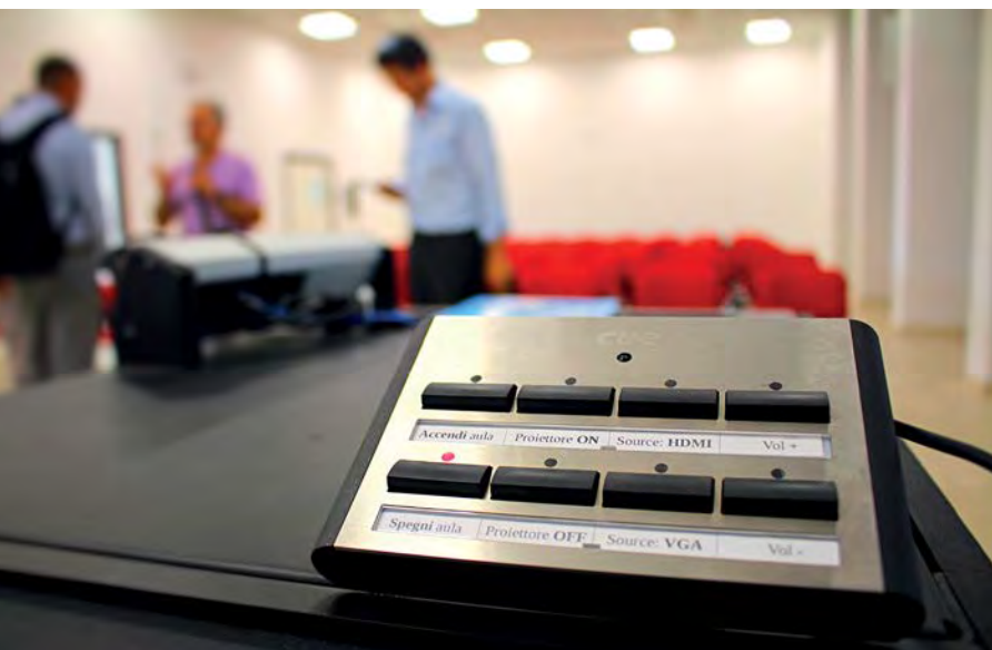
La centralina di controllo Cue, che consente di gestire sia lo switcher/scaler di aula che il mixer audio
